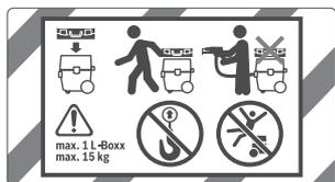
Pour transporter l'aspirateur et pour un stockage peu encombrant des accessoires et/ou de l'outil électroportatif, vous pouvez monter une L-Boxx sur la partie supérieure de l'aspirateur.
